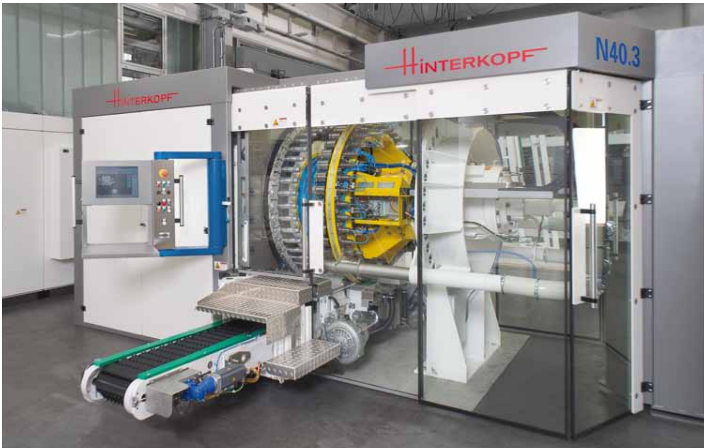
Schwenkbares und in Höhe und Neigung anpassbares Ein- und Auslaufband für gute Zugänglichkeit
