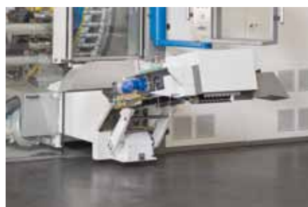
Schwenkbares und in Höhe und Neigung anpassbares Ein- und Auslaufband für gute Zugänglichkeit
