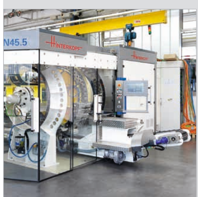
Schwenkbares und in Höhe und Neigung anpassbares Ein- und Auslaufband für gute Zugänglichkeit.
