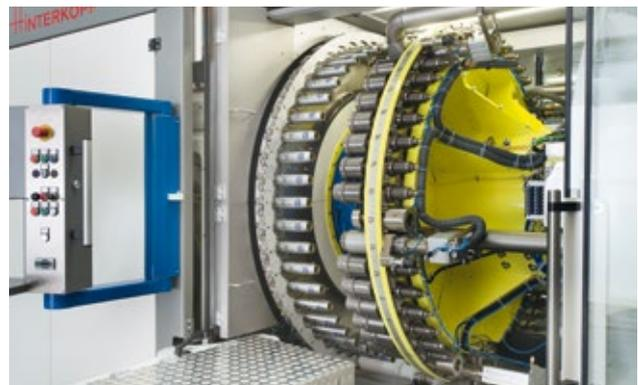
Die Einziehmaschine N50.3 von Hinterkopf eröffnet mit 50 Bearbeitungsstationen neue Möglichkeiten der Formgebung.
