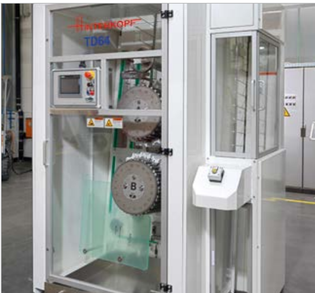
In den Produktaufnahmen werden die Produkte mittels Vakuum festgehalten und von den Kettenstäben abgezogen.
