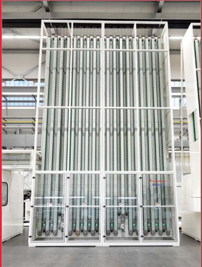
Der Speicher ist durch trennende Schutzeinrichtungen abgesichert.
